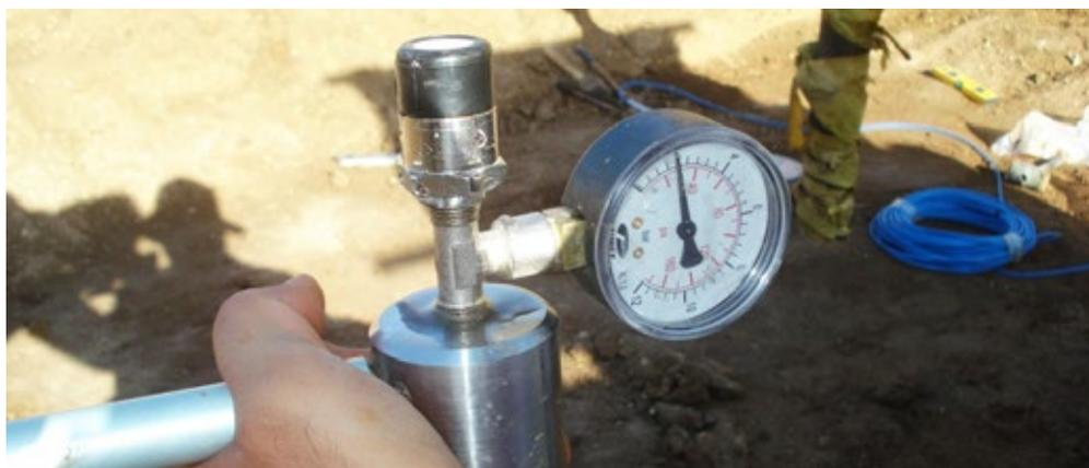
Saturación del filtro HAE con dispositivo de saturación
